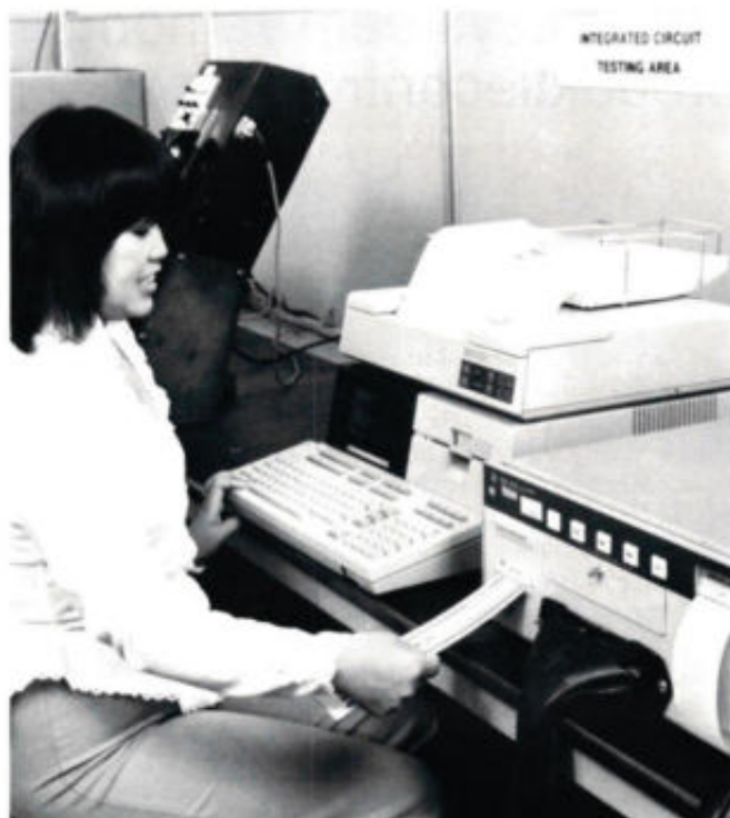
De nieuwe HP 5046B Digital Integrated Circuit Test System is een verbeterde versie van de HP 5046A.
